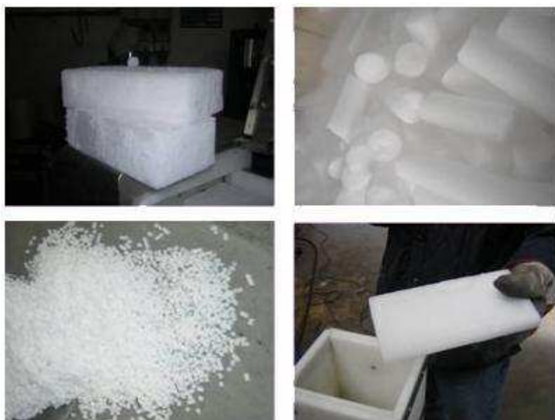
Foto 5. Ghiaccio secco ottenuto dalla CO 2 pressurizzata e spinta attraverso stampi che possono avere diverse forme. Nel sistema automatizzato di pulitura si utilizzano piccoli pellets di ghiaccio secco.
