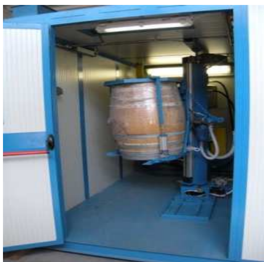
Sistema automatizzato per il trattamento delle barrique con sabbiatura con ghiaccio secco
